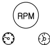
RPM 버튼을 누르면 모터가 설정 RPM값으로 돌기 시작하고 RPM LAMP가 점등됩니다. 또한 TIMER LAMP가 점등하며 정해진 시간 TIMER는 동작합니다. 시간이 00 : 00 이면 계속 해서 모터는 돌입니다.
